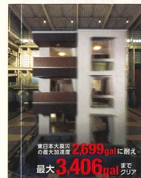
住友林業では、万が一の大震災を想定し、3階建ての実物大モデル※で振動実験を行い、耐震性能を検証しています。
